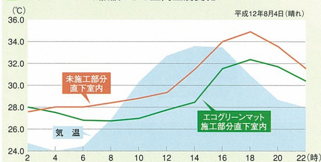
■エコグリーンマット敷設による室内温度変化
