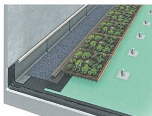
③ユニットを設置
