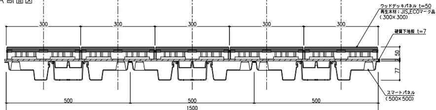
スマートパネル用ウッドデッキ設置参考図<ステップタイプ(飛び石型)> S=1:10
