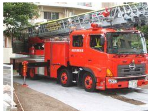
写真1 消防車乗り入れ試験(グラスミックス敷き均し後)
